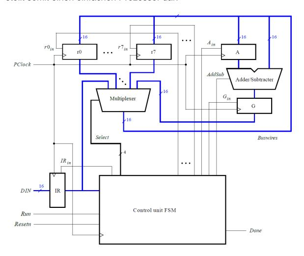
Die Eingabe der Daten erfolgt über den Eingang DIN mit 16bit Breite. Diese Daten werden im Register IR zwischengespeichert. Mit Hilfe des Multiplexers können Daten von beliebigen Registern in jedes andere beliebige Register transferiert werden, z.B. vom IR in die *general purpose register* r0 – r7. Der Ausgang des Multiplexers steht an den Leitungen *BusWires* zur Verfügung. Die FSM steuert dabei die *Select* Lines, die die angesprochenen Register freischalten.
