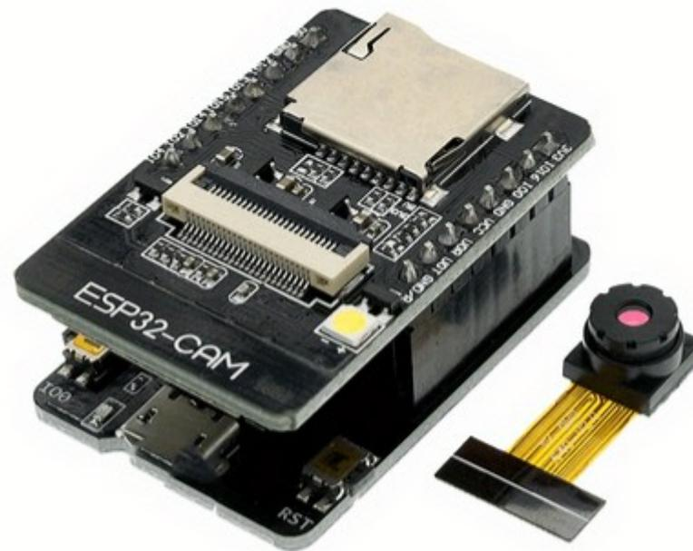
Beschreibung von RUI SANTOS verwendet die Arduino-Software. Dabei wird mittels Boardmanager auf eine Version 1.04 der ESP32 Compilerversion zurückgegriffen.
